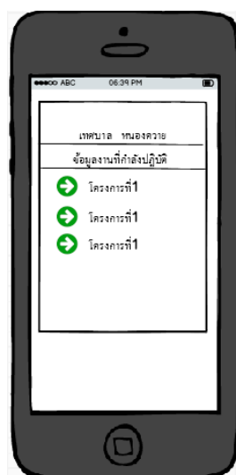
ภาพที่ 3.48 แสดงการออกแบบหน้าข้อมูลงานที่กำลังปฏิบัติสำหรับแอปพลิเคชันของผู้ดูแล ระบบและหัวหน้างาน จากภาพที่ 3.48 หน้าแสดงข้อมูลงานที่กำลังปฏิบัติสำหรับแอปพลิเคชันโดยมี หัวข้อของงานที่กำลังปฏิบัติแสดงอยู่สามารถเลือกเพื่อดูข้อมูลการปฏิบัติได้
